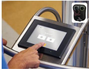
Lancement du cycle directement sur le dispositif via l'écran tactile ou à l'aide de la commande à distance
